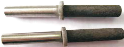
图3 718+P110SS电偶对腐蚀形貌
