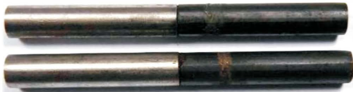
图2 825+P110SS电偶对腐蚀形貌
